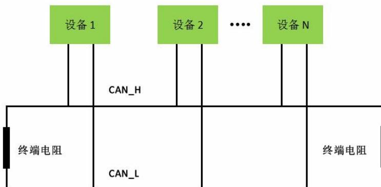
注意：CAN-bus 电缆可以使用普通双绞线、屏蔽双绞线。若通讯距离超过 1Km，应保证线的截面积大于Φ 1.0mm<sup>2</sup>，具体规格应根据距离而定，常规是随距离的加长而适当加大。
